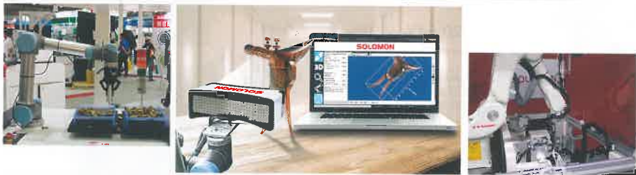
■3D視覺就像幫機械手臂裝上人的眼睛，讓機器能分辨、揀選物品（左圖），將博物館藏品360度掃描、數位建模（中圖），甚至辨別每隻鞋子鞋帶孔細微的位置差異，將鞋繫上鞋帶（右圖）。
